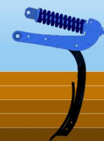
Pour obtenir l'effet souhaité, les éléments de travail doivent être enfoncés assez superficiellement
